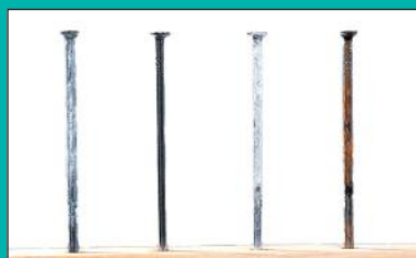
Próbki gwoździ po 24 godzinach (1cykl) w komorze wilgotnościowej
